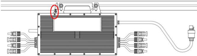
用螺丝刀将接地支架线安装在微型逆变器顶部的接地孔，将螺丝拧紧至 2N.m。
