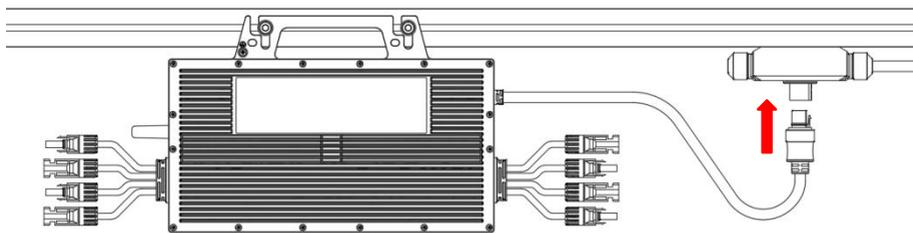
\*同一分支线路微型逆变器的数量，不能超过规定的最大连接数量。
